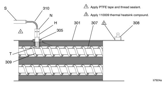
Fig. 16 Thermocouple
